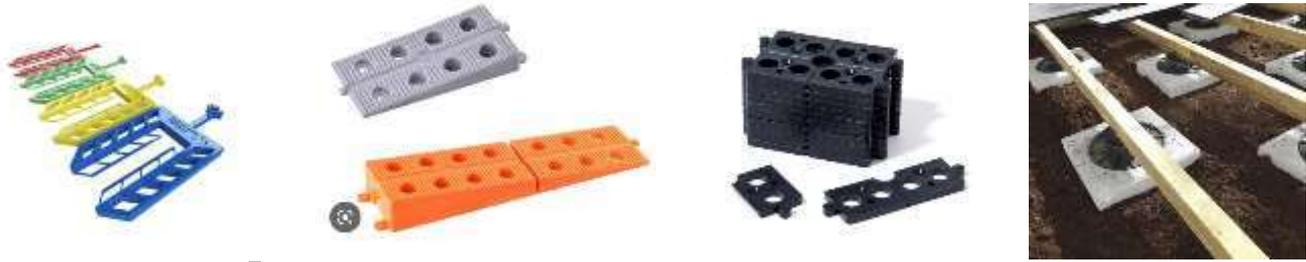
Afin d'éviter la formation d'un point de rosée au dos de vos lames de terrasses, Il est important de désolidariser la structure du support avec de petites cales plastique de 3 à 10 mm afin de permettre un parfait écoulement des eaux. En respectant ces simples consignes vous évitez : - Un tuilage excessif des lames, un fendillement de celles-ci , l'apparition de gerces.
