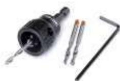
Il est indispensable de pré-percer lames et lambourdes avant vissage. Ceci vous permettra de réaliser un vissage perpendiculaire esthétique et facilitera l'alignement parfait des vis. De plus, dans le cas de bois exotiques dont la dureté est très importante, les éléments de fixation ont tendance à se casser lors de leur mise en œuvre si aucun avant-trou n'est réalisé.
